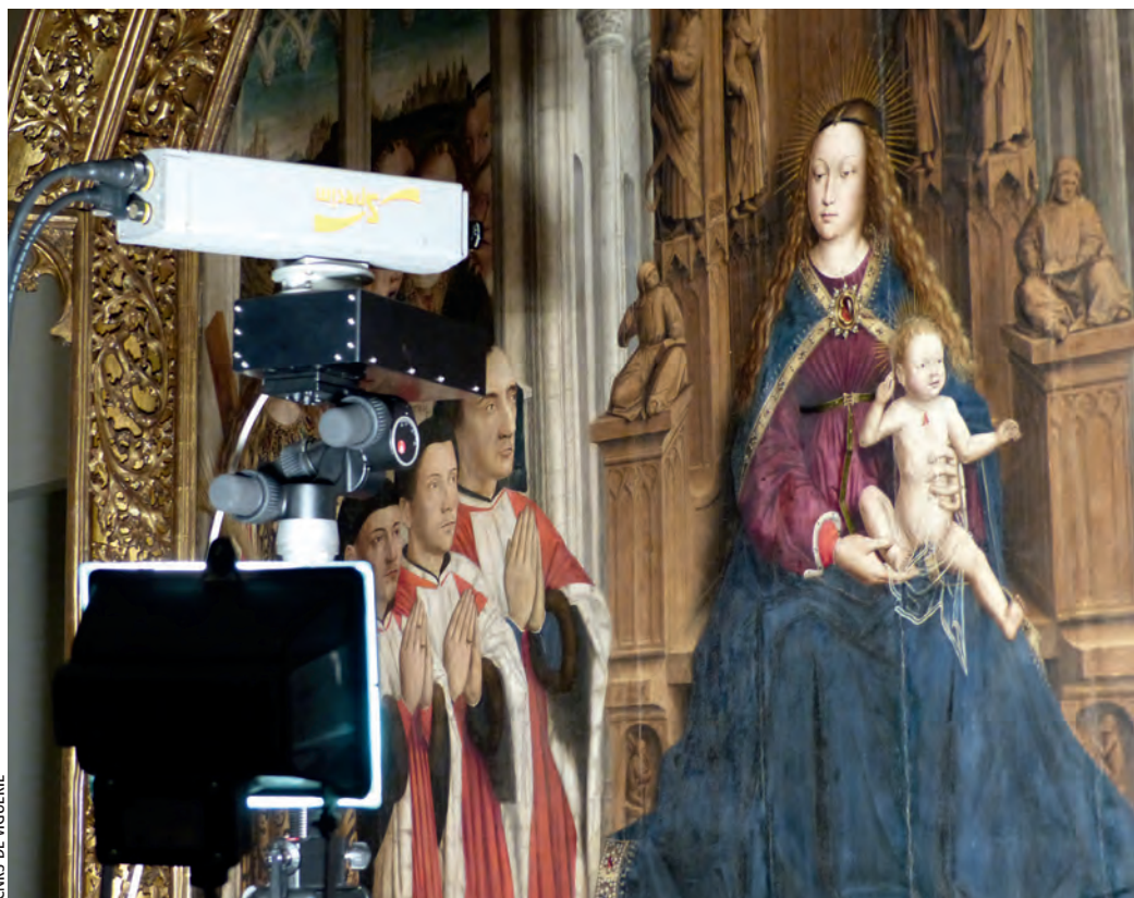
La caméra hyperspectrale, technique de pointe qui utilise tout le spectre, des rayons X à l'infrarouge, permet d'identifier un grand nombre de pigments et de colorants organiques. Ici, l'équipe du Laboratoire d'archéologie moléculaire et structurale utilise un modèle portatif au Musée national d'art de Catalogne.
